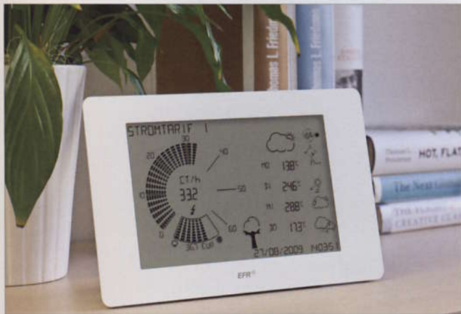
Beim EFR-Inhome-Display sind Energieverbrauch, Temperatur, Zeit und Wettervorhersage sofort ersichtlich
