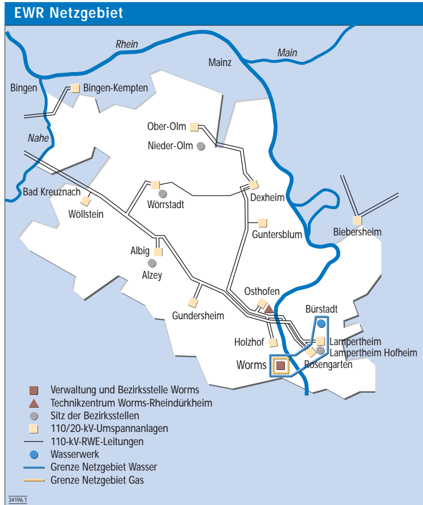
Bild 1. Das Netzgebiet der EWR AG erstreckt sich über 1 248 km 2 und umfasst 129 Gemeinden. Innerhalb des Netzes befinden sich rd. 16 000 Rundsteuerempfänger, mit denen 19 500 Kundenanlagen gesteuert werden
